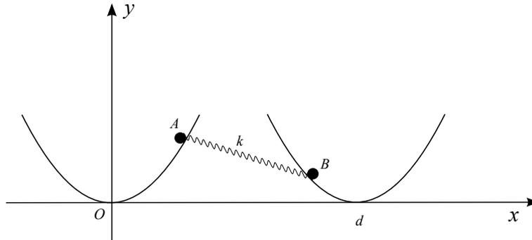
Due punti materiali A e B di massa identica  $m$  possono scorrere senza attrito su due guide paraboliche fissate su un piano verticale, sotto l'azione della forza di gravità. Le due guide hanno equazioni  $y = \frac{1}{2}ax^2$  e  $y = \frac{1}{2}b(x-d)^2$  dove  $a, b, d$  sono delle costanti reali. I due punti sono connessi da una molla di lunghezza di riposo nulla e costante elastica  $k$ .
