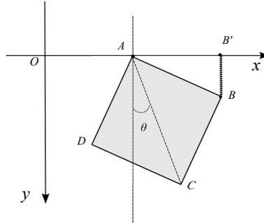
Una lamina quadrata  $ABCD$ , omogenea di massa  $m$  e diagonale  $\overline{AC} = 2a$  si muove in un piano verticale  $Oxy$  con il vertice  $A$  vincolato a scorrere senza attrito lungo l'asse  $x$ . All'estremo  $B$ , vedi figura, è applicata una forza elastica  $\vec{F}_A = -k \overline{BB'}$ , con  $B'$  proiezione ortogonale del vertice  $B$  sull'asse  $x$ . Sulla lastra, oltre alla forza elastica, agisce la forza peso.
